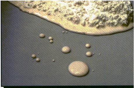
Beton auf hydrophober Isolierplatte
