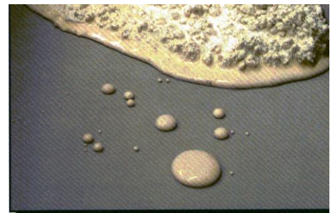
Beton auf hydrophober Isolierplatte
