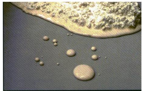
Beton auf hydrophober Isolierplatte
