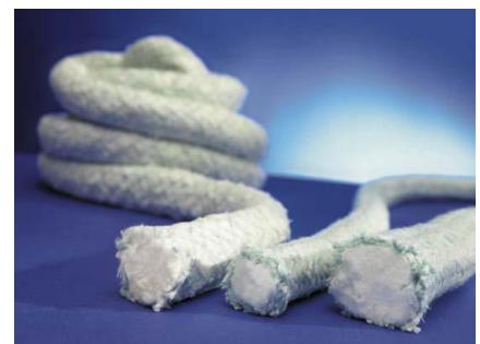
Isolier- und Dichtschnüre mit einem weichen Kern aus Mattenstreifen auf Basis von Kalzium-Magnesium-Silikatfasern mit hervorragender Biolöslichkeit und einer eng- oder weitmaschigen Umflechtung aus Kalzium-Magnesium-Silikatfasern; chromstahldrahtverstärkt (I); auch graphitisiert (C) lieferbar
