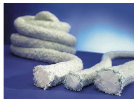
Isolier- und Dichtschnüre mit einem weichen Kern aus Mattenstreifen auf Basis von Kalzium-Magnesium-Silikatfasern mit hervorragender Biolöslichkeit und einer eng- oder weitmaschigen Umflechtung aus Kalzium-Magnesium-Silikatfasern; chromstahldrahtverstärkt (I); auch graphitiert (C) lieferbar
