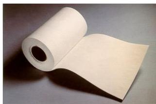
Diese Isolierpapiere auf Erdalkalifaserbasis entsprechend der EU-Norm ECB/TM/26, Revision 7, Nota Q, Directive 97/69/EC. Die Fasern sind von einer Einstufung als krebserregend ausgenommen und bedürfen somit auch keiner Kennzeichnung
