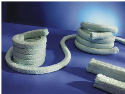
Isolier- und Dichtschnüre mit einem weichen Kern aus Mattenstreifen auf Basis von Kalzium-Magnesium-Silikatfasern (ISOCECERAM 110 BIO / ISOMAT 110 BIO) mit hervorragender Biolöslichkeit und einer eng- oder weitmaschigen Umflechtung aus Kalzium-Magnesium-Silikatfasern; chromstahldrahtverstärkt (I); auch graphitiert (C) lieferbar
