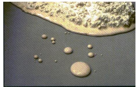
Beton auf hydrophober Isolierplatte
