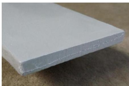
Isolierplatte mit PE-Folie kaschiert
