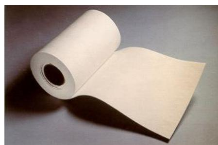
Diese Isolierpapiere auf Erdalkalifaserbasis entsprechen der EU-Norm ECB/TM/26, Revision 7, Nota Q, Directive 97/69/EC. Die Fasern sind von einer Einstufung als krebsfördernd ausgenommen und bedürfen somit auch keiner Kennzeichnung
