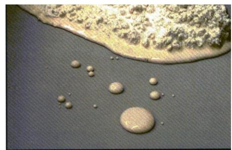
Beton auf hydrophober Isolierplatte
